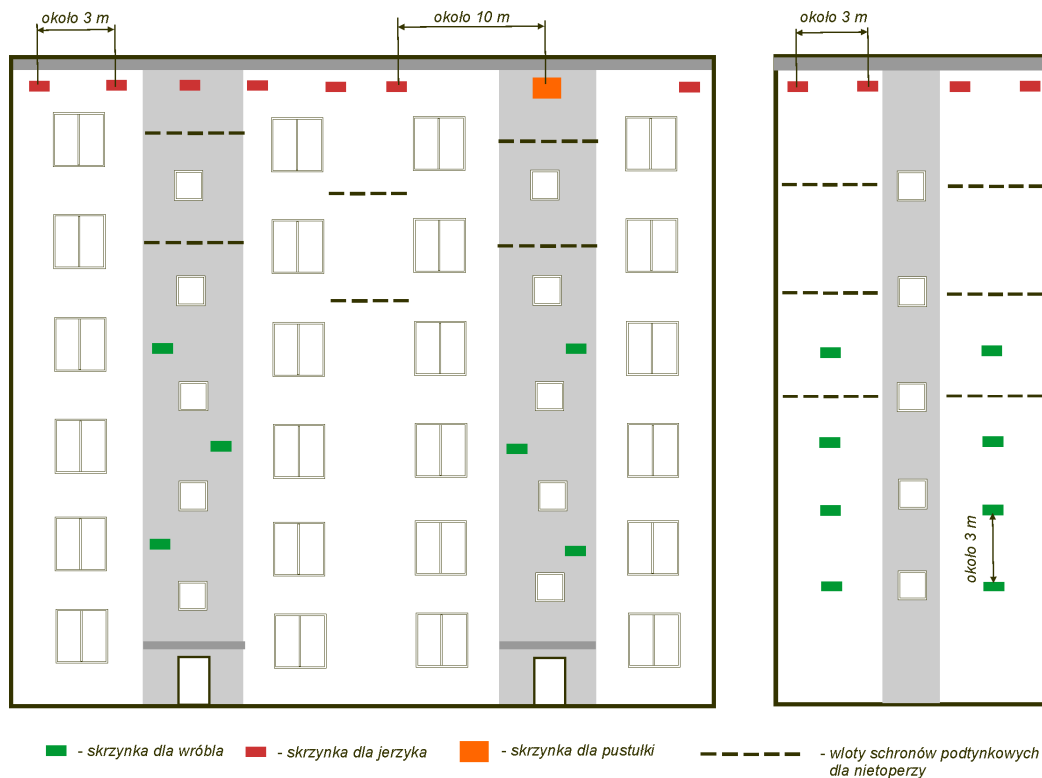
Rys. 6. Przykładowy schemat rozmieszczenia skrzynek dla ptaków i nietoperzy na budynku o wysokości powyżej czterech kondygnacji
