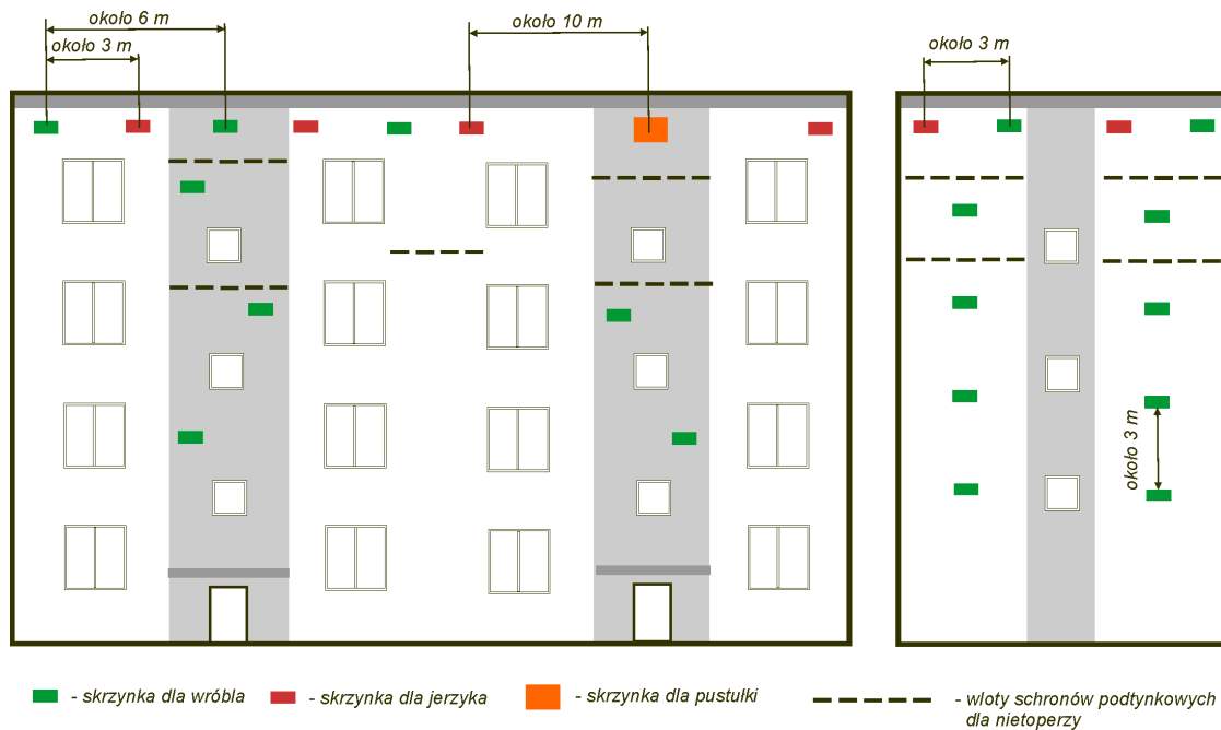
Rys. 5. Przykładowy schemat rozmieszczenia skrzynek dla ptaków i nietoperzy na budynku o wysokości do czterech kondygnacji
